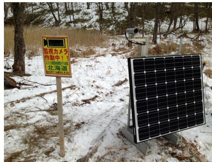
釧路湿原内のエゾシカ捕獲罠に設置した監視カメラ。独立電源とFOMA回線を利用することで、電気がない場所でエゾシカの動態をモニタリングすることが可能です。
