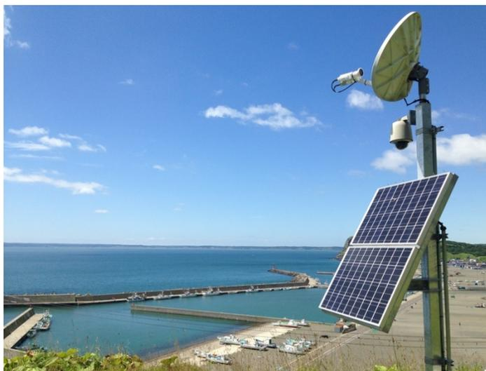
厚岸町床潭漁港に設置した衛星回線を利用した独立電源型防災カメラ。
